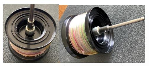
上2写真。スプール。本機ではスプールを保持するベアリングは他の場所にあるのでスプール軸が見えていますが、軸根元部分が腐食により変色しています。その形状からこれを洗浄するのは難しく、若干の磨きを実施し取り付けております。現時点では動作に支障はありませんが、この状態が進むとスプールを交換する事になりますので、定期的なメンテナンスをお勧めします。パネル側のベアリングについてはシャリ感も無く正常な状態と判断し、洗浄脱脂後、取り付けております。
