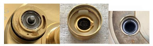
上左写真。メカニカルブレーキを外したところ。上中写真。そのノブ。上右写真。カバーを外し裏側から。左写真の中央のシャフトはスプールシャフトです。その周りがスプールを支えるベアリングです。右写真のベアリングはピニオンギアを支えています。
