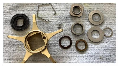
上写真。ハンドル軸と構成している部品となります。油分が殆ど無い状態。ワッシャー2 枚に腐食が発生していますが、動作に影響が出る状態でも無く、そうした箇所でもない為、今回はそのまま使用しています。
