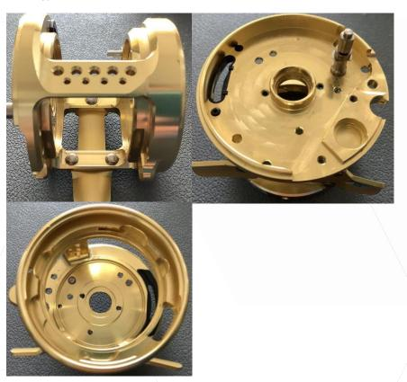
こちらはフレームの写真です。特に破損個所等も無いため、洗浄後、グリスアップと同時に組み上げます。
