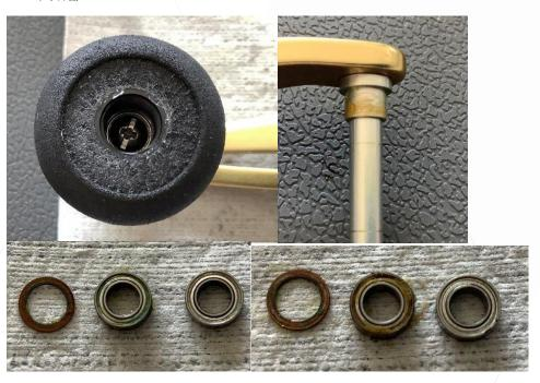
上左写真。ハンドルノブキャップを取り外したもの。上右写真。ハンドルノブ軸部分。下 2 写真。両方のノブ内のベアリングとワッシャー。下写真は左からワッシャー、ベアリング(根元側)、ベアリング(ハンドルノブ内)となります。
