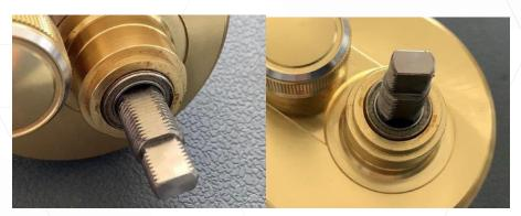
上左写真。ハンドル軸部分。上右写真。軸付け根のベアリング。ハンドル軸や周りについては多少汚れがあるものの腐食や破損も無く問題ありません。軸付け根のベアリングについても回転テストでは問題なく、洗浄再注油の上使用しています。
