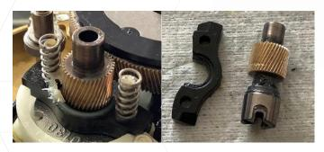
上左写真。取り付けられているピニオンギア。上右写真。ピニオンギアの構成部品。油分の減りは見られますが、ギア自体の状態は良く、腐食や摩耗も発生しておりません。
