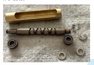
上写真。レベルワインダーを構成している部品。ベアリングとシャフトの一部で腐食が見られます。片方のベアリングは殆ど回らない為、双方を同時交換しています。(※2)
