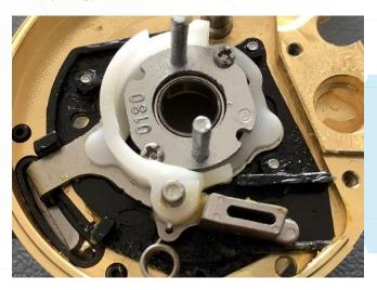
上写真。クラッチ機構になります。全体的に油分の減りは見られますが、構成されている部品は正常な状態で腐食なども見られません。
